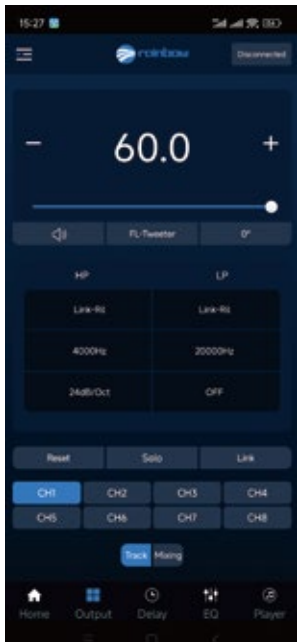
Cruce de Frecuencias
