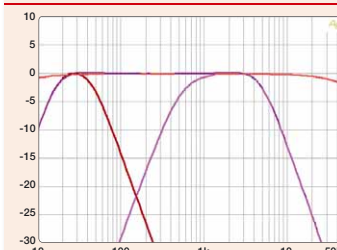
Die One läuft als analoge Mono auch fullrange. Sie hat die gleichen Einstellbereiche wie ihre mehrkanaligen Schwestern
